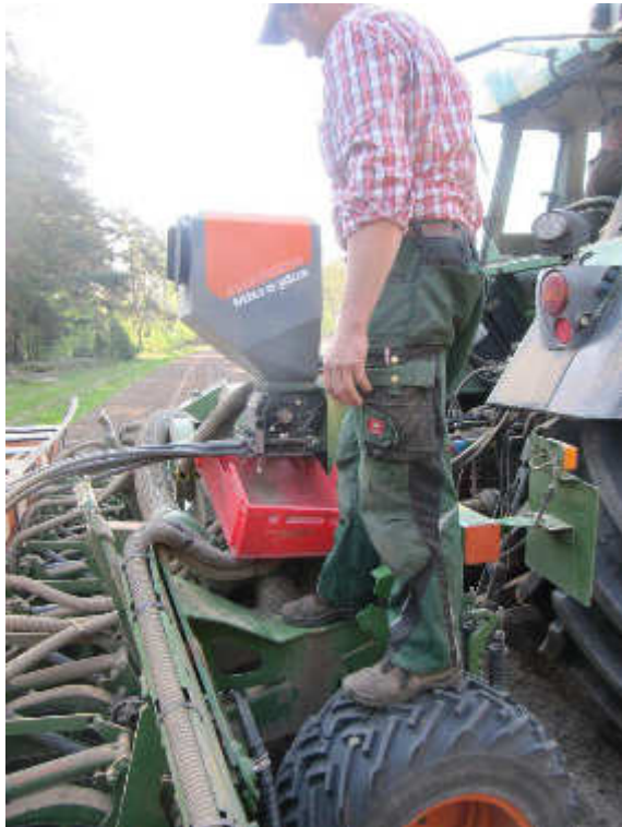
Abdrehprobe mit Mykorrhiza am Mikrogranulatstreuer zur Maisaussaat
