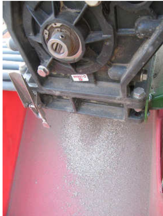
Abdrehprobe mit Mykorrhiza am Mikrogranulatstreuer zur Maisaussaat
