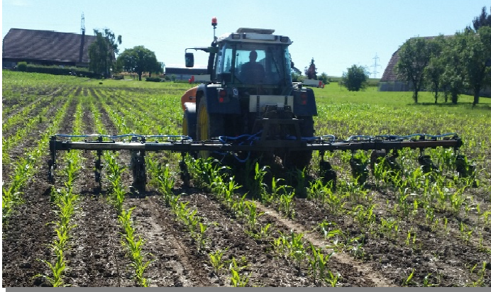
Abb. 3 Scheibengerät Körnermais 75cm Reihenweite
