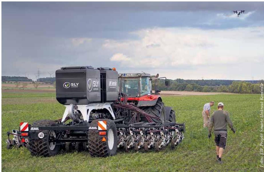
Die Aussaat erfolgte unter anderem mit einer Direktsaatmaschine SLY von Agrisem.
