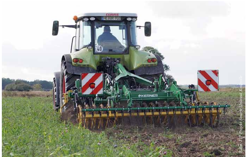
Grubbern mit Kerner Corona zur mechanischen Kontrolle des Aufwuchses.
