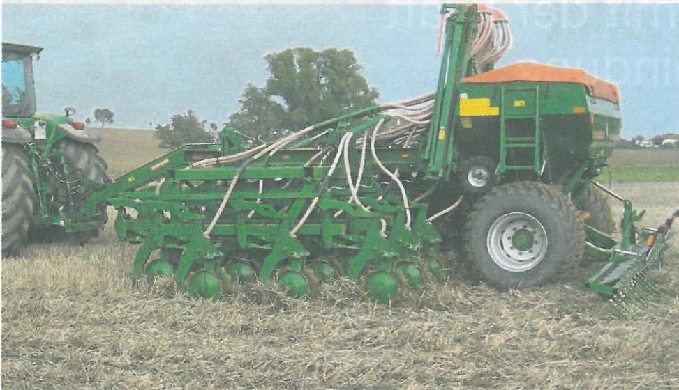
**Direktsämaschine im Einsatz.** Einige Vorteile der Direktsaat sind die weitestgehend erhaltende Bodenstruktur und die Minimierung des Erosionsrisikos.
