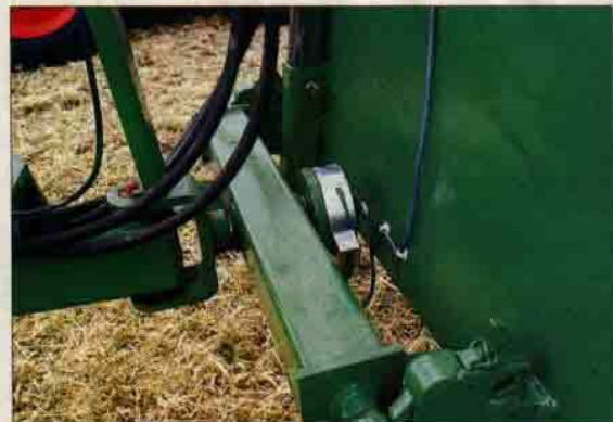
Mit der elektronischen Zugkraftmessdose wird der Zugkraftbedarf von angehängten Bodenbearbeitungsgeräten gemessen. Die Zugkraftwerte werden teilflächenspezifisch aufgezeichnet
