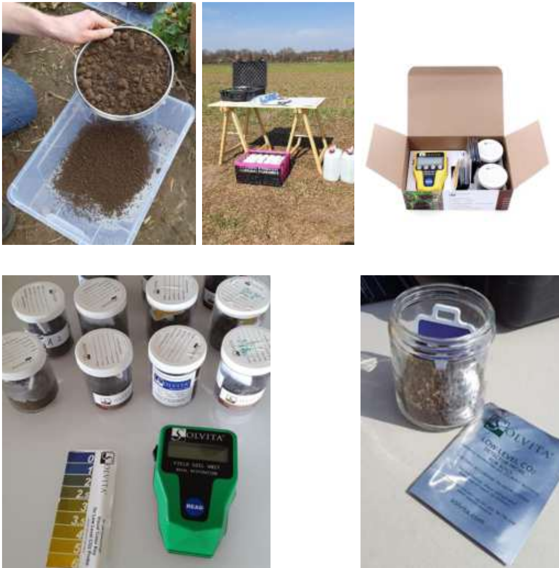
Bild 5: Abfolge des Bodenlebens test
