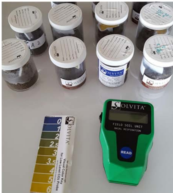
Bild 8: Abfolge des Solvita Bodenlebens test
