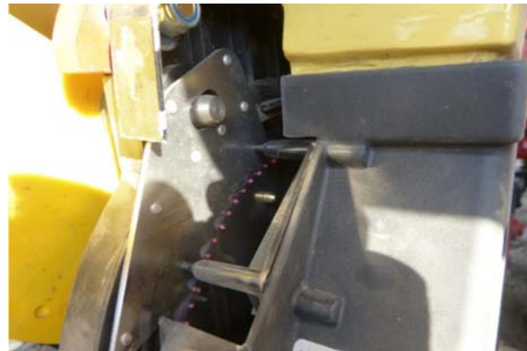
Bild 5: Vereinzelung (Maternac) der Rapskörner
