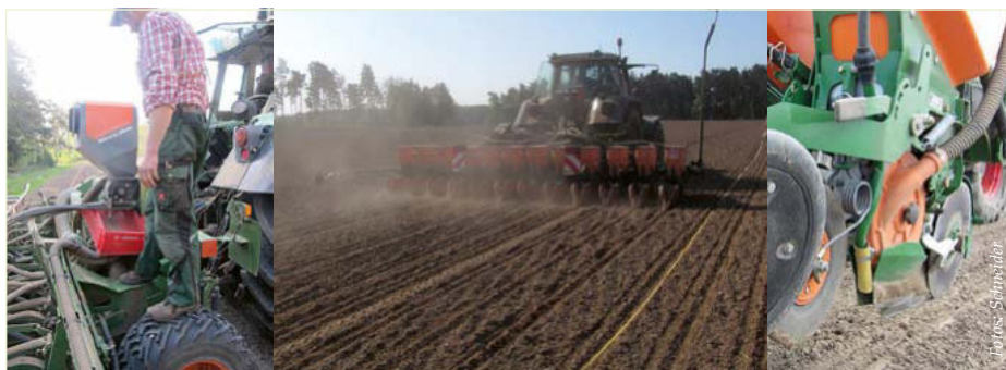
Abb. 1: Versuchsanlage mit Abdreprobe am aufgesatteltem Mikrogranulatstreuer (li.) sowie veränderter Zuführung des Granulats zum Saatband (re.).
