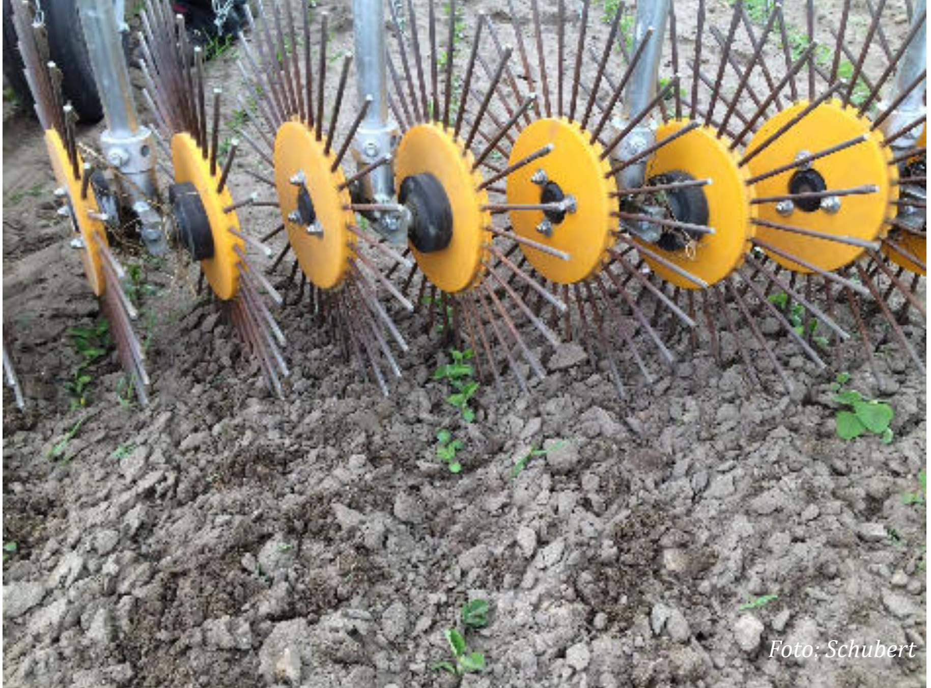
Rollstriegel Aerostar Rotation , eingesetzt im Ökoanbau von Sojabohnen.
