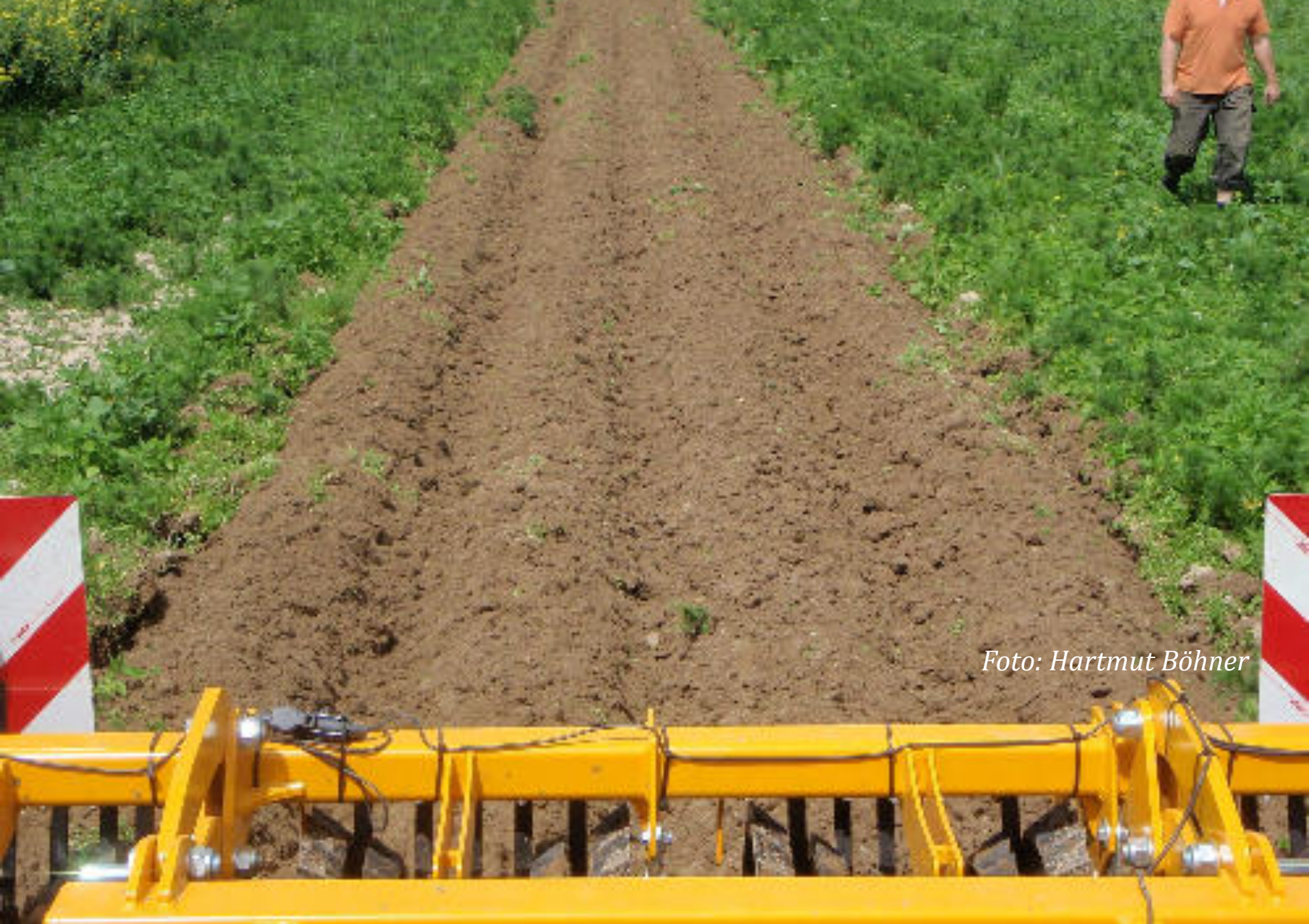
Dammkulturgerät Prototyp „Aktivator“ beim Aufhäufeln der Dämme
