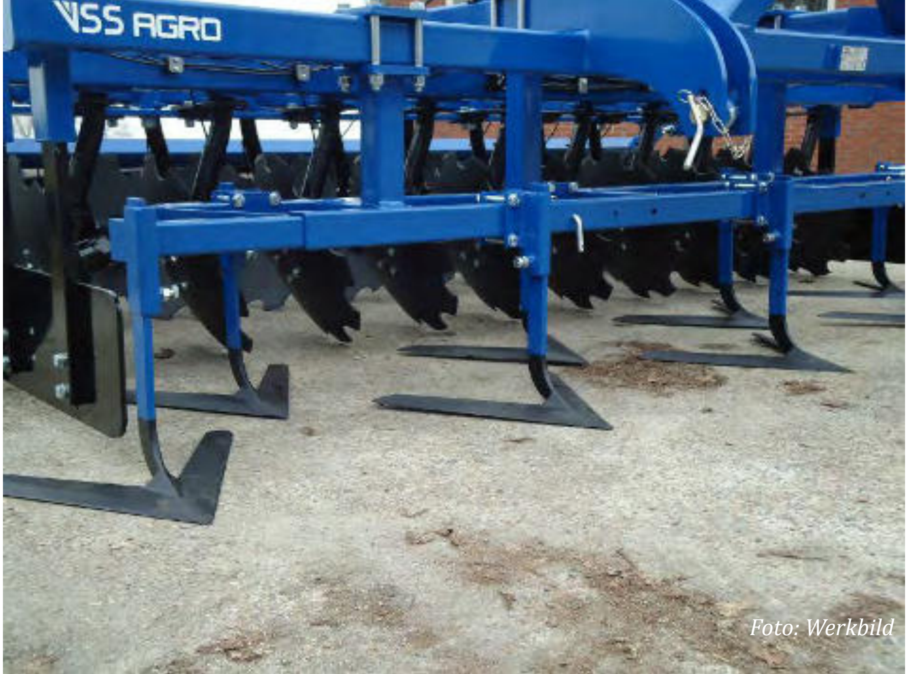
Spezialmaschine von VSS Agro (Niederlande) für nichtwendende Bodenbearbeitung
