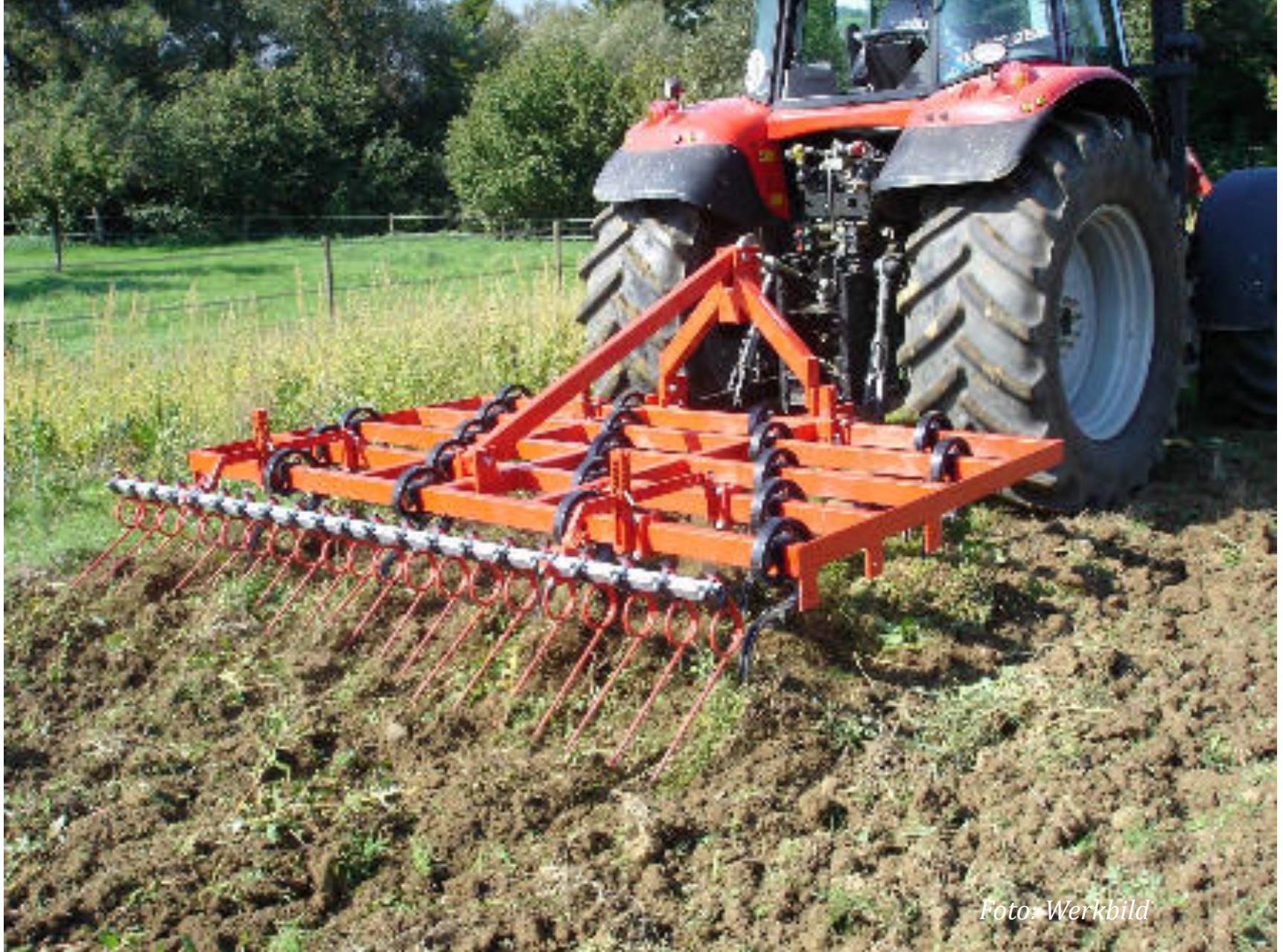
Supermaxx von Güttler: Großfederzinkenegge ohne Walze
