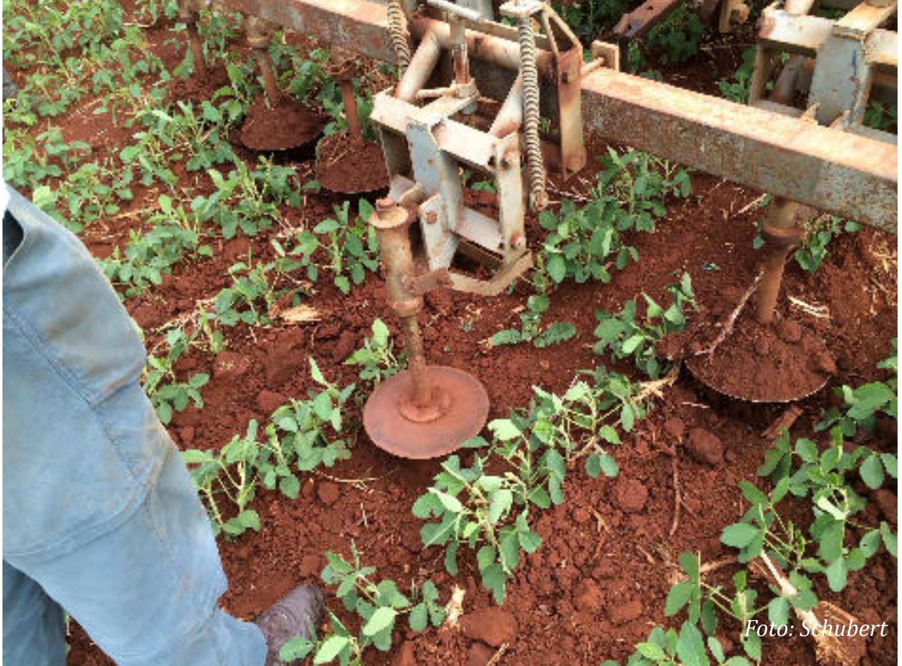
Tellergrubber aus Brasilien, eingesetzt im Ökoanbau von Sojabohnen.
