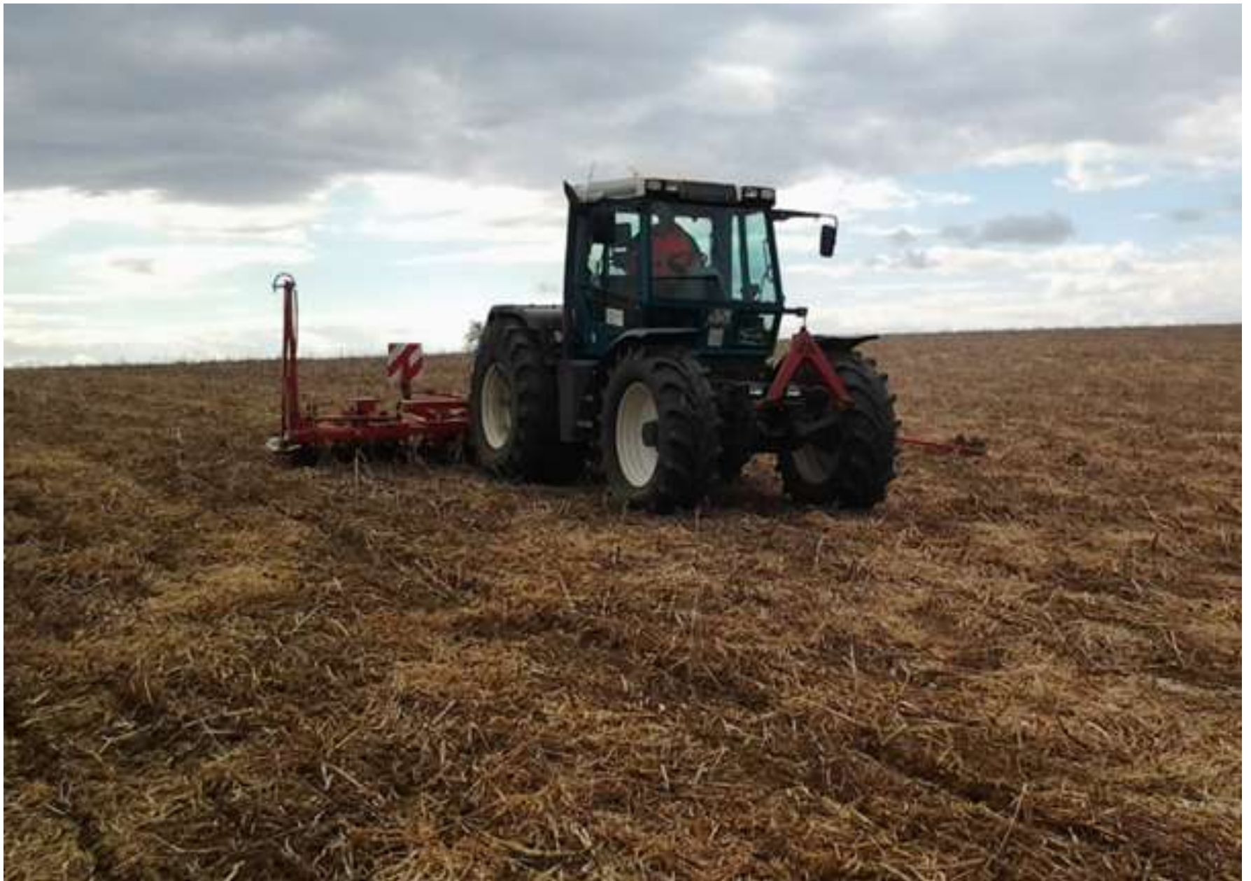
Direktsaat mit 800er Reifen bei 0,4bar
