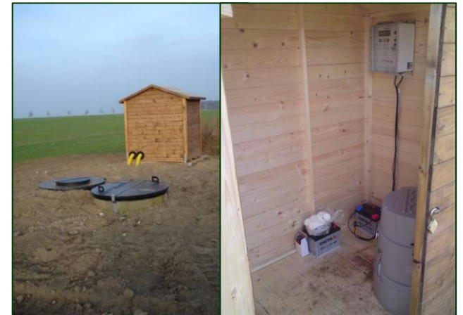
Messgerätehaus und automatischer Probenehmer
